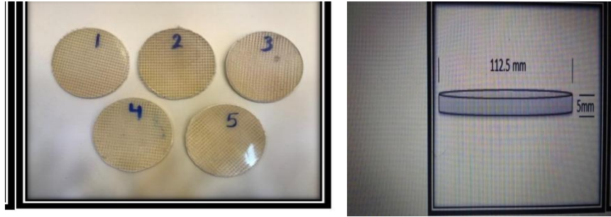
الشكل (2) يوضح النماذج المستعملة في قياس التوصيلية الحرارية
