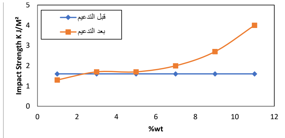
الشكل (5) العلاقة بين مقاومة الصدمة (I.S) والنسب المئوية الوزنية للاييبوكسي
