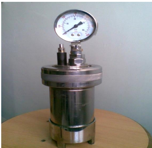
الشكل ( 2 ) : مفاعل الضغط المخلخل المستخدم قيد الدراسة
