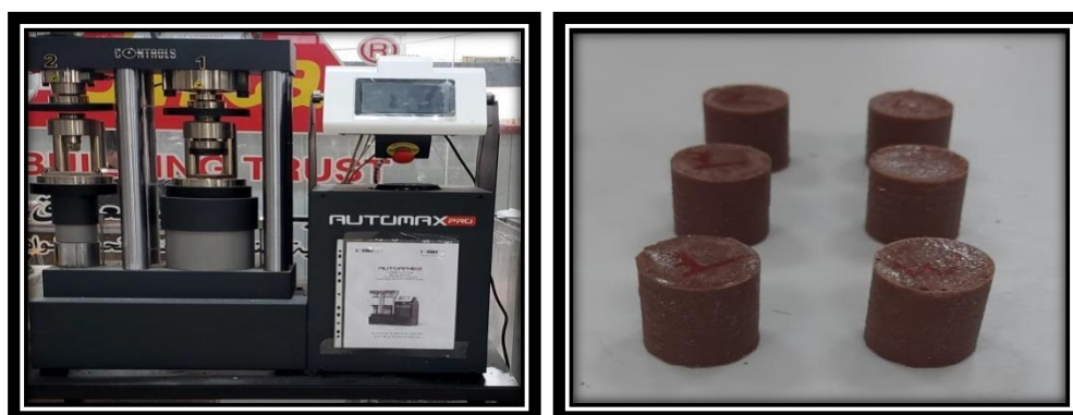
الشكل (٤): شكل العينة لاختبار مقاومة الانضغاط الشكل (٥): جهاز اختبار مقاومة الانضغاط
